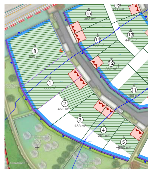
Ill.1 : extrait du plan réglementaire : limites sur lesquelles la surverse par débordement peut être positionnée
