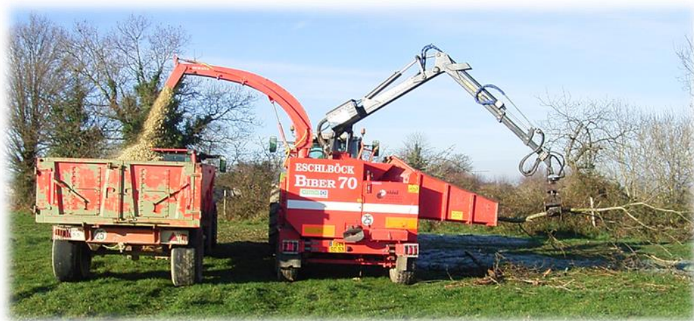
Chantier de déchiquetage de bois issu de l'entretien des haies pour la production de plaquettes bocagères.
