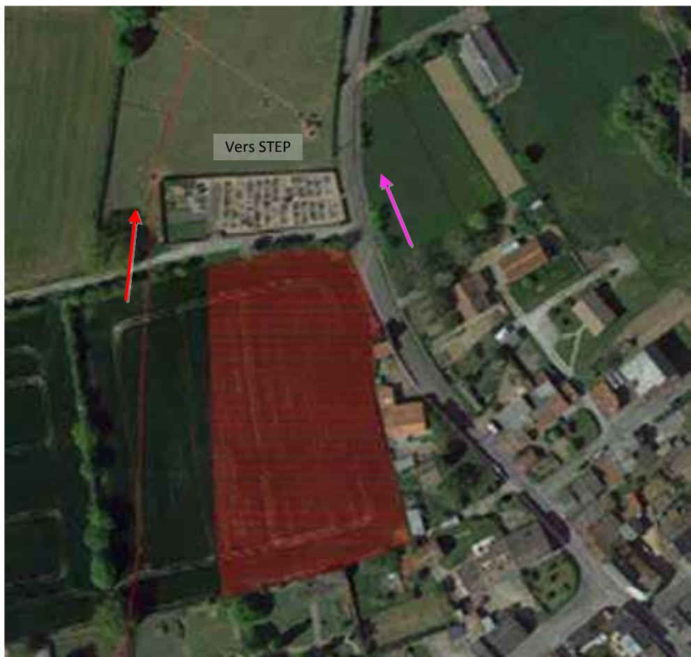
Cette zone AU2 est longée par un réseau EU (prof : >1,5 m et DN200) à l'ouest et un réseau UN à l'est (prof : >1 m et DN300). **Aucun coût de raccordement ne devrait être engagé.**
